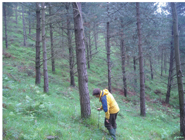
Foto 4. Empleo de barrena para medición de profundidad y, a la vez, para tomar muestras a distintas profundidades
